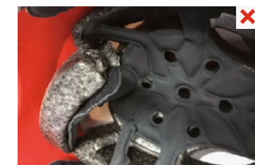
poškození skořepiny zahřátím
