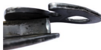
úbytek materiálu na kyvné straně zachycovače pádu
