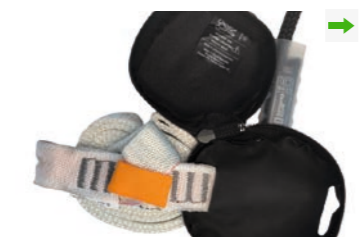
kontrolní proužek je bez poškození
