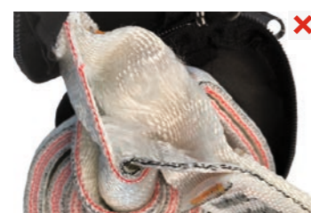
kontrolní proužek tlumiče je mimo obal - zjevné poškození
