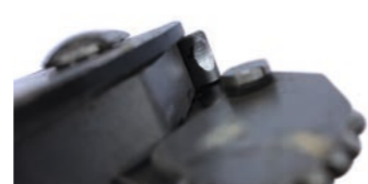
úbytek materiálu na pevné straně zachycovače pádu
