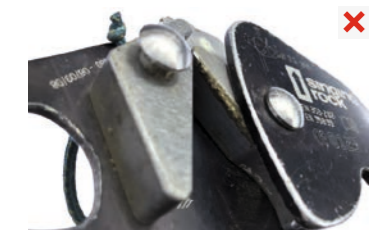
znečištění třecí plochy
