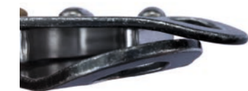
znečištění třecí plochy
