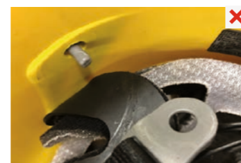
poškození uchycení hlavového kříže
