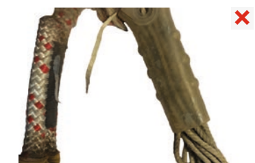
porušený opleť lana
