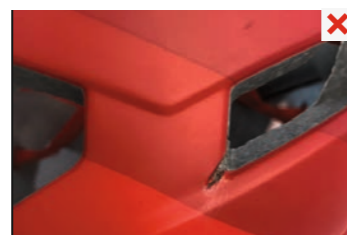
narušená tlumicí vložka
