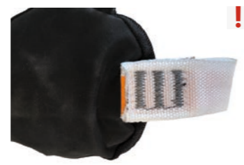
kontrolní proužek tlumiče je mimo obal - zjevné poškození
